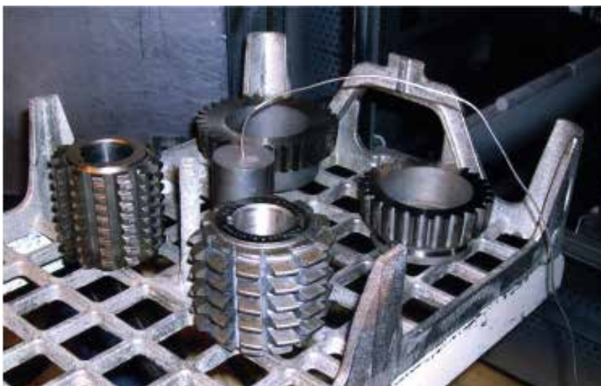
为了控制热处理工艺中的材料温度一般要使用“样块”，其壁厚要与最大的热处理工件的壁厚相近
